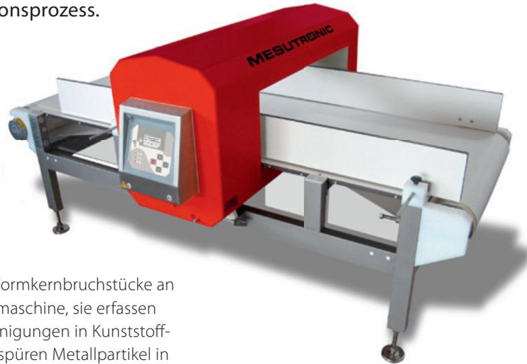
Sie erkennen Formkernbruchstücke an der Spritzgießmaschine, sie erfassen Metallverunreinigungen in Kunststoffwalzfeldern, sie spüren Metallpartikel in Säcken mit Kunststoffgranulat auf oder sind in Mühlenbeschickungsbänder integriert. Dabei überwachen sie Produktionsprozesse, schützen Folienkalander, werden zur Warenausgangskontrolle eingesetzt und schützen Schneidmühlen – um hier nur einige
